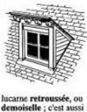
lucarne rampante ou en chien couché
