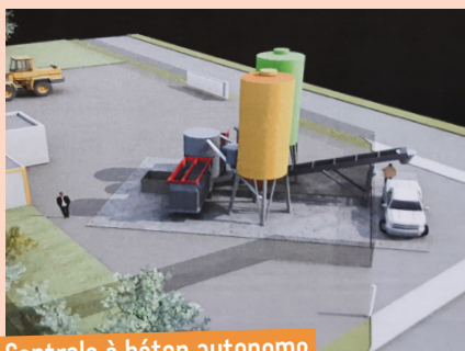
Centrale à béton autonome
